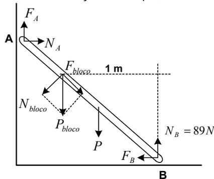
Na direção vertical  $R_y = 0 \Rightarrow F_A + 89 = P_{bloco} + P$  ;
