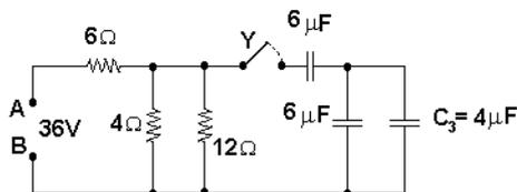
Resolvendo a associação em paralelo dos capacitores, temos:  $C_{P1} = 4\mu + 6\mu = 10\mu\text{F}$ . Resolvendo a associação em série dos capacitores, temos:
