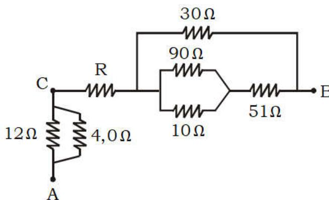
Sabe-se que a resistência equivalente entre os pontos **A** e **B** vale  $40,0 \Omega$  e a d.d.p. entre os pontos **A** e **C** vale  $15,0 \text{ V}$ . A potência dissipada, por efeito Joule, no resistor **R**, em watt, é de:
