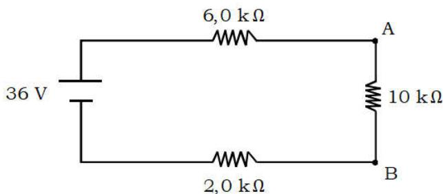
Considere o circuito elétrico acima, onde a resistência interna do gerador é desprezível quando comparada com as demais resistências.
